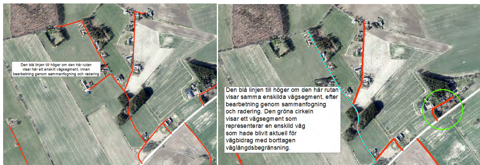
Figur 1: Vänster: obearbetat kartunderlag i rött. Höger: kartunderlag där utfarter raderats och vägsegment sammanfogats. Ljusblått visar ett enskild markerat vägsegment i respektive kartbild, tillhörandes samma enskilda väghållare i verkligheten. Det vänstra vägsegmentet är 34 meter. Det högra vägsegmentet är 820 meter. Den gröna cirkeln visar exempel på en tillkommande väg om väglängdsbegränsning avskaffas.
