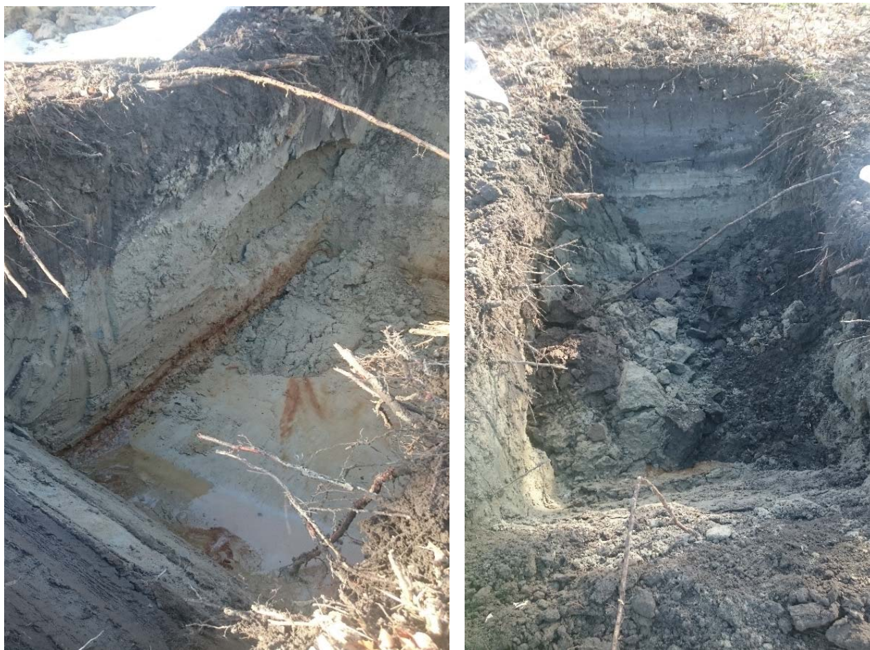
Figur 5: Grop nr 2 i område C. Foto till vänster: På nivån runt 1 m noteras rostutfällning. Fotot taget mot syd. Foto till höger: Väggar har rasat in. Fotot är taget ca 20 min efter att grävning avslutats. Foto taget mot sydväst.
