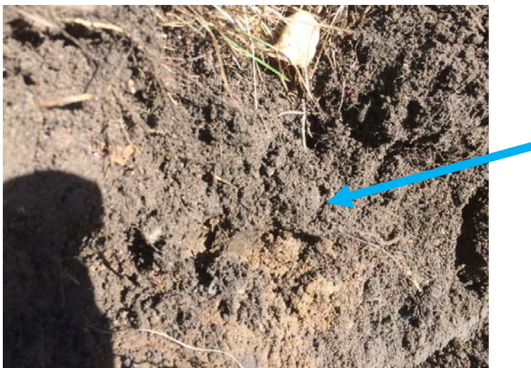
Figur 13: Små kvicksilverdroppar hittades på ca 10-20 cm djup, ca 9,4 m sydväst om boulebanan. Kan anas i bilden som små vita prickar. Fotoriktning åt norr, 2017-03-22.
