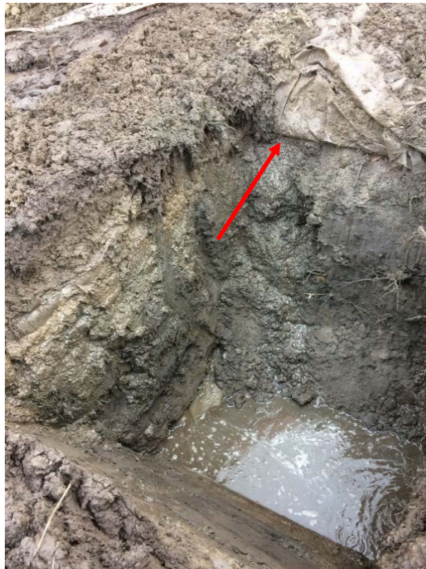
Figur 7: Provgrop i område D. Foto till vänster schaktvägg mot ån och nordost. Fiberduk kan noteras vid pil. Fotot till höger är taget mot syd.
